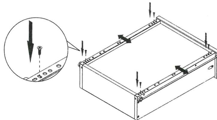
Verwendem Sie nun für die Zentralschraube (Schiene Mitte) das freie, nicht vorgebohrte Loch für die dritte Befestigung und ist vollbracht!
