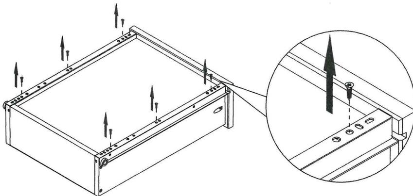
Zur Neu Befestigung der Schienen benutzen Sie die «querliegenden» Langlöcher vorne und hinten an den Schienen. Achten Sie dabei darauf, dass die Schubladenführungsschiene vorne an der Schubladenfront anliegt bzw. anstößt. Drücken Sie die Schiene fest an die Schubladenseitenwange und die Schrauben anschließ
